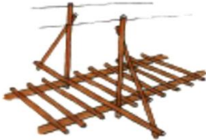
Λεπτομέρεια για τη στήριξη των κάθετων ξύλων και των κουπαστών
